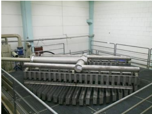
Rinnenverteiler montiert auf Verteilerprüfstand P114_RVT_TestFacilities_pic4
