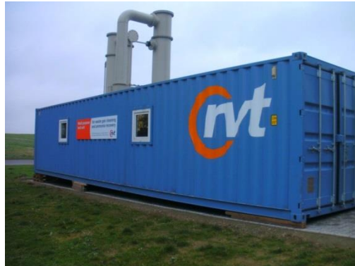
Mobile Multifunktionsanlage zur Ammoniakstrippung und Abgasreinigung im einsatzbereiten Zustand mit montierter Stripp- und Absorptionskolonne. P114_RVT_TestFacilities_pic5
