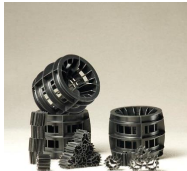
Biologische Aufwuchsträger Bioflow 40 (groß) hergestellt im Spritzgießverfahren und Bioflow 9 (klein) produziert auf einer Extrusionsmaschine bieten in der aeroben biologischen Abwasserreinigung den Mikroorganismen Aufwuchsflächen. P414_RVT_ExtensionOfInjectionMolding_pic4
